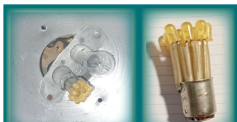
Petre Cichirdan: Becul cu leduri, 21 W / 24 Vcc, inventat în 1994, înlocuitor al becului cu filament incandescent, utilizat la semaforizarea mobilă și la semaforizarea orașului Petroșani-1996
